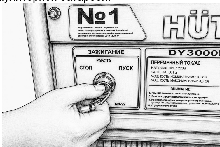
Рис. 20. Запуск двигателя электростартером
