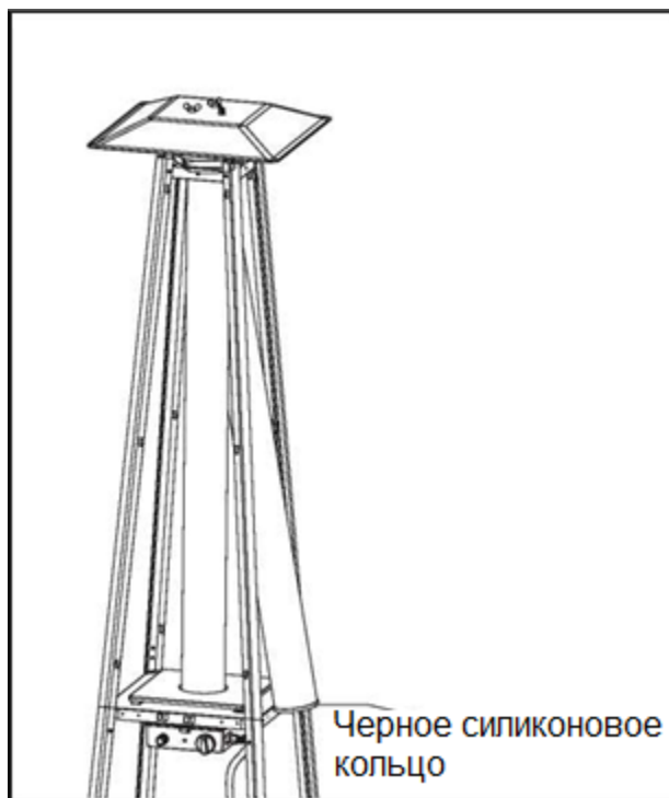
Рис. 10. Установка стеклянной колбы.
